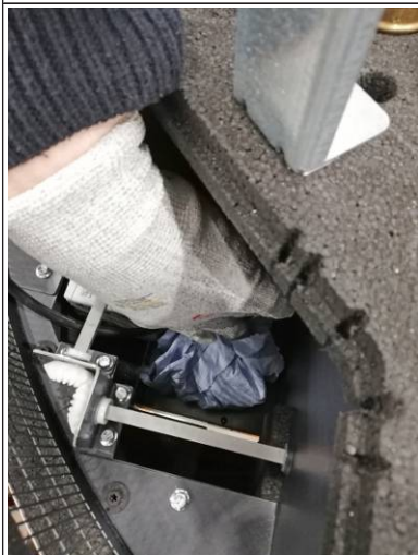
Fig. 34: Pulire il pozzetto della pompa
