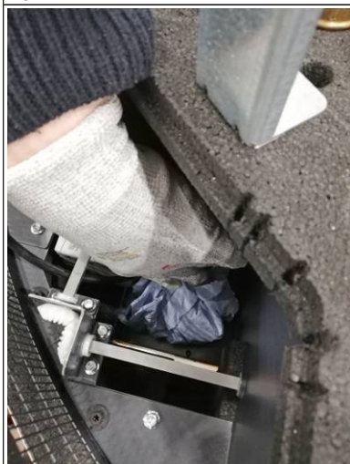
Fig. 36: Pulire il pozzetto della pompa
