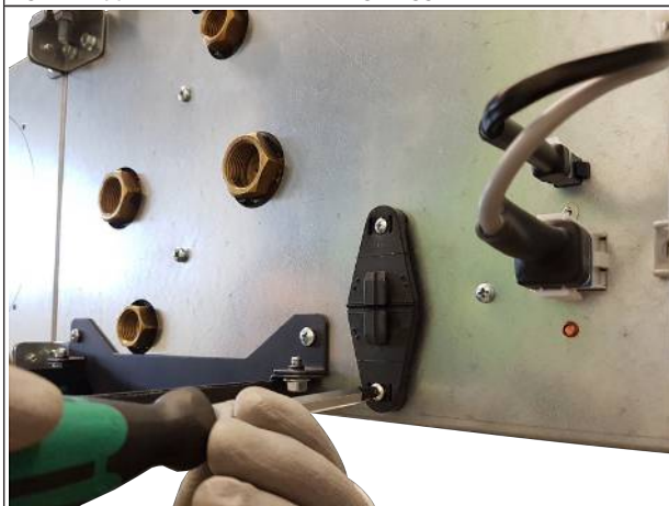
Fig. 21: Applicazione supporto per pompa
