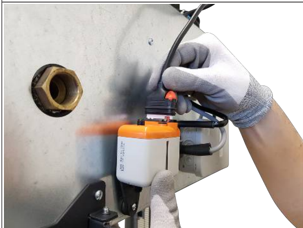
Fig. 26: Inserimento alimentazione di tensione
