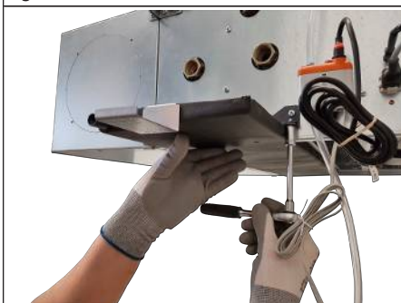
Fig. 61: Allentamento e mantenimento in posizione della vaschetta di raccolta della condensa
