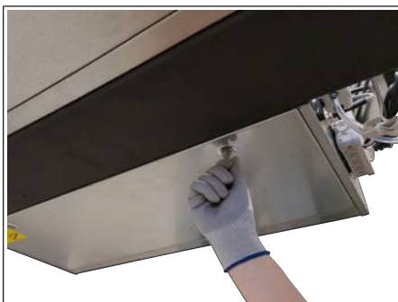
Fig. 50: Apertura del blocco rotante
