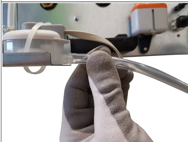
Fig. 27: Collegamento tubo flessibile di aspirazione
