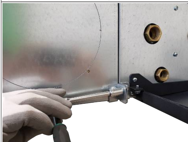
Fig. 11: Serraggio esterno delle viti
