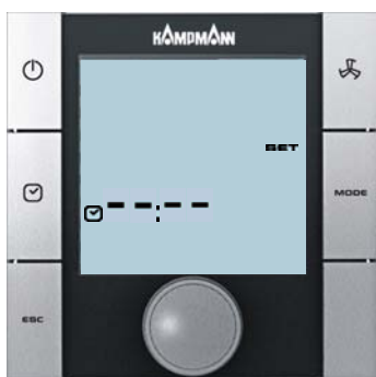
Impostazione per non visualizzare l'ora corrente nella visualizzazione standard
