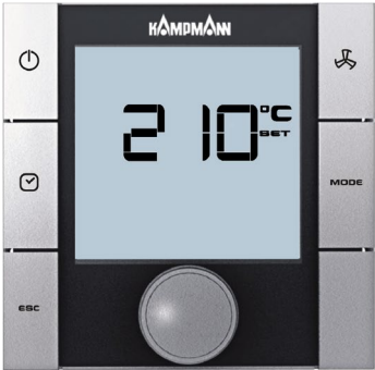
Parametro P36=0 Impostazione della temperatura al valore nominale "assoluto"
