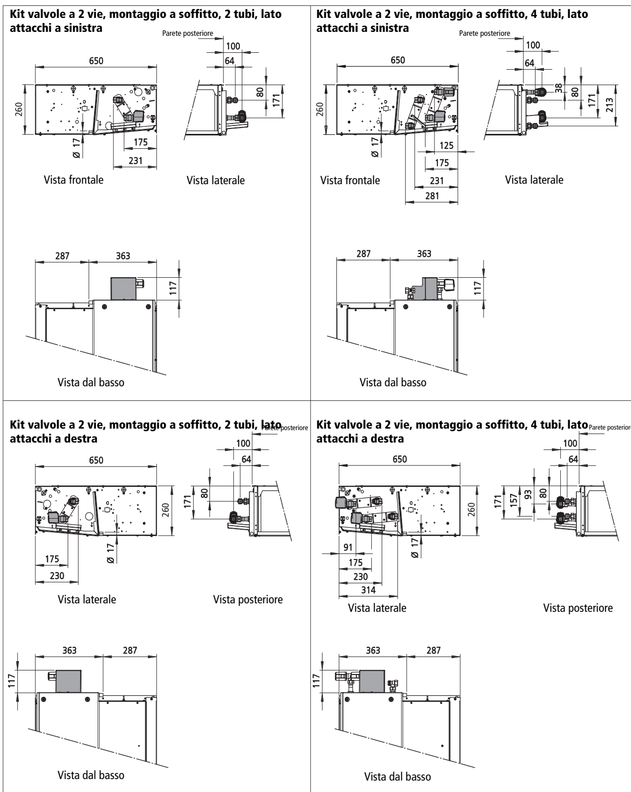
Fig. 12: Dimensioni kit valvole a 2 vie (esecuzione a soffitto)
