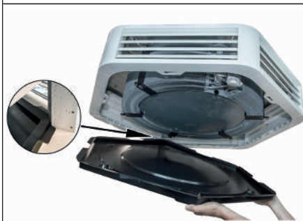
Fig. 34: Abbassamento della vaschetta di raccolta condensa
