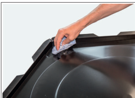
Fig. 35: Pulizia della vaschetta di raccolta condensa
